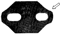
写真—3 C1タイプの破断形状
