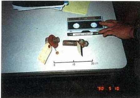
写真-3 せん断破壊したE9上のボルト (1 in 径)
