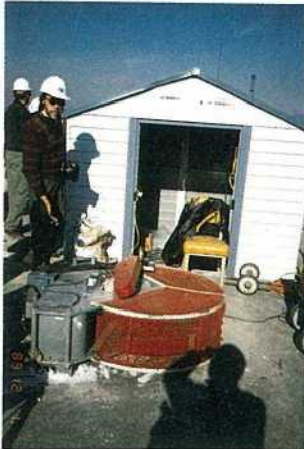
写真一八 強制振動実験に用いられた回転型起振器 (京都大学工学部 竹脇 出氏提供)
