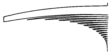
図-2 振子の反発試験の記録
