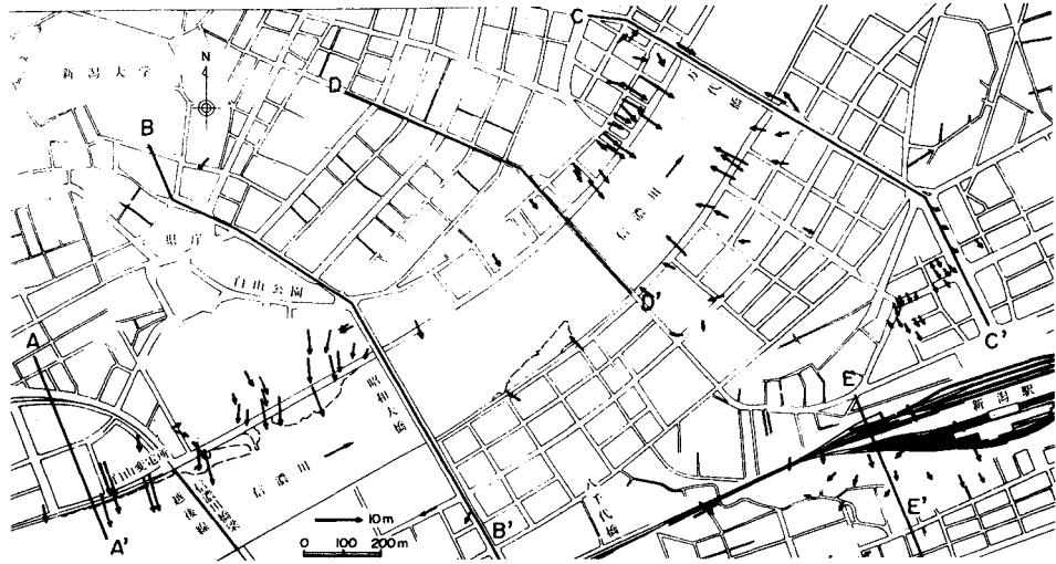
図-2 新潟市の土層断面の位置と永久変位の概略
