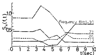
Fig. 4 スペクトル密度の時間的変化（ある特定の振動数 f 成分の時間的変化, Taft SE 69^\circ ）
