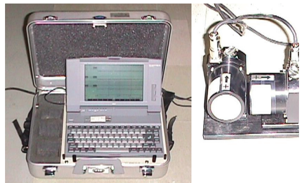
Figure 6. Handy seismometer (SPC-35F: VSE-15D velocity seismometer)
