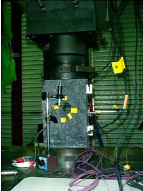
写真-1：岩盤ブロックの圧縮破壊試験
