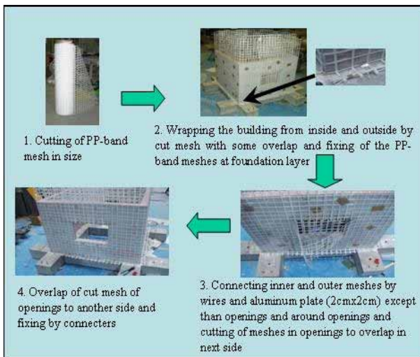
図3 PPバンド補強法の手順
