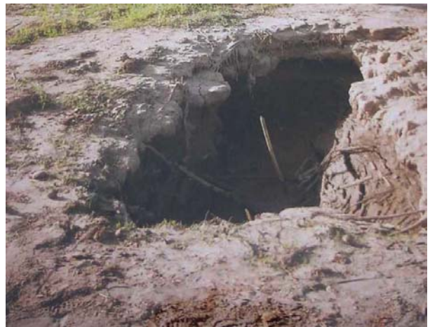
写真-3：Göynük suyu川の近くの噴砂孔
