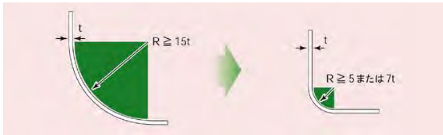
図-5.2.3 冷間曲げ加工 12)
