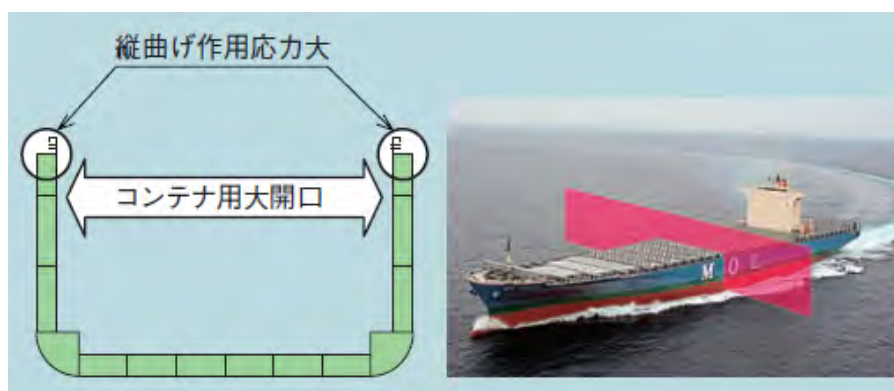
図-6.2.1 コンテナ船の構造の特長 22)
