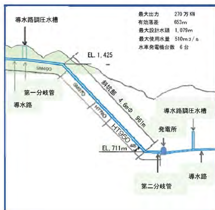
図-6.4.2 神流川発電所の水圧鉄管 41)
