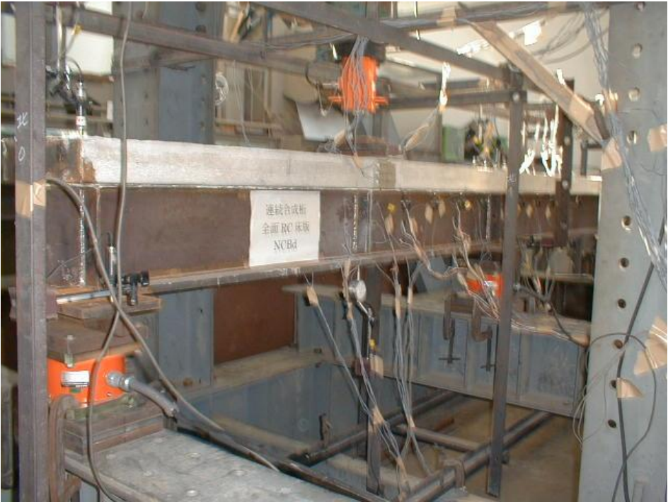
支点反力測定用ロードセル設置 (左支点, 中間支点)
