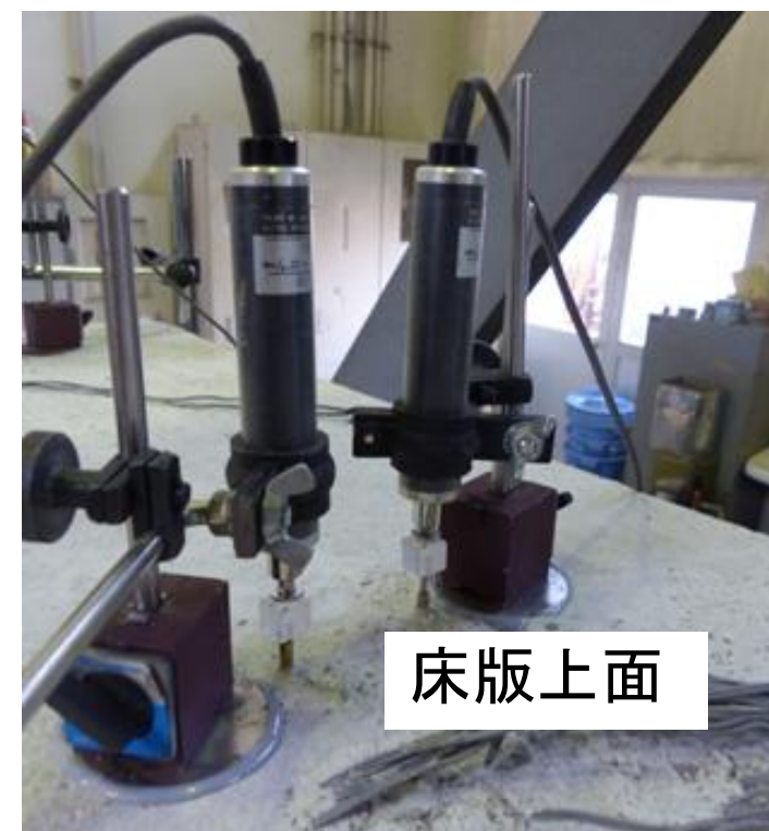
スタッド軸方向変位計測関係
