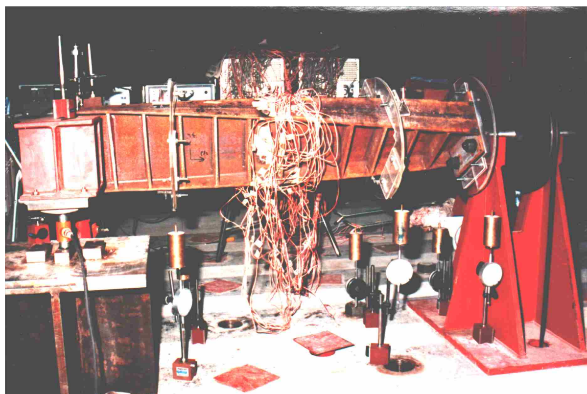
H型鋼のねじり実験
