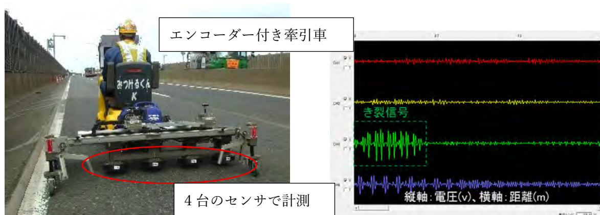
図-3.4.3 距離情報を付加した牽引車と位置情報と連動した波形データ
