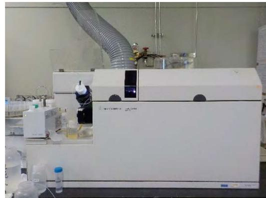
図-7.3.4 ICP質量分析装置 (ICP/MS)
