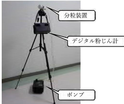
図-7.3.8 分粒装置を用いた測定方法
