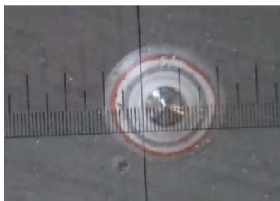
図-7.1.1 カット式膜厚計を用いた膜厚測定の様子
