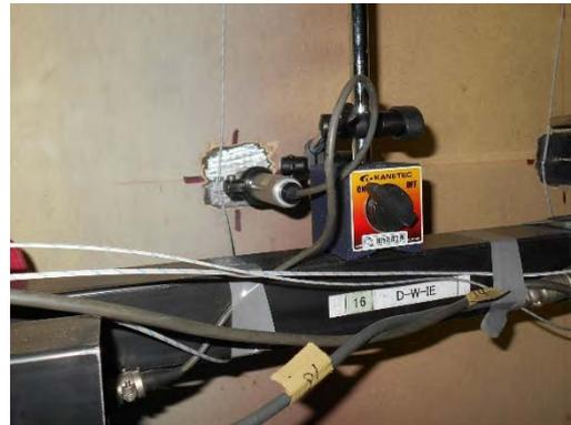
図-7.2.9 変位計の設置状況
