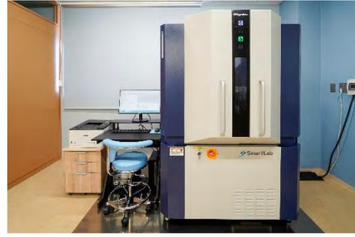
図-7.3.7 X線回折装置
