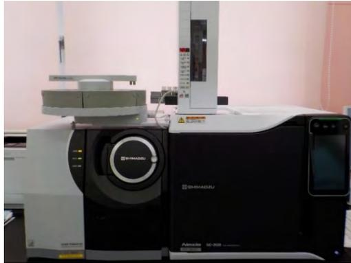
図-7.3.2 ガスクロマトグラフ質量分析装置 (GC/MS/MS)
