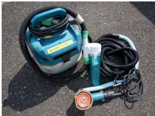
図-7.3.1 塗膜採取装置
