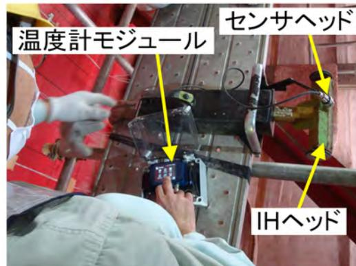
図-5.1.1 IHヘッド（加熱コイル）の先端に設置された温度計モジュール[5.1]
