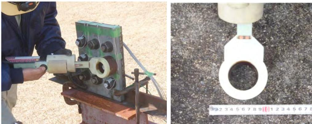
図-5.3.1 ボルト用の加熱コイル[5.6]
