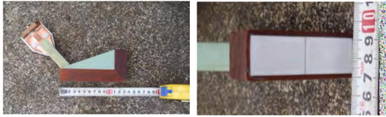
図-5.3.3 狭隘部，部材交差部用のコイルと添接板の塗膜剥離状況[5.6]
