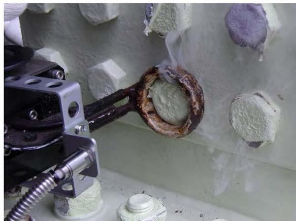
図-5.3.2 ボルト専用の IH 装置[5.7]
