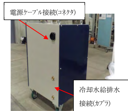
(c) 電源装置裏面
