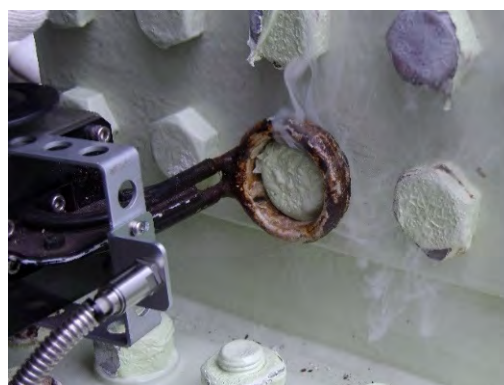
図-3.1.6 いよ技研の加熱装置の構成および外観
