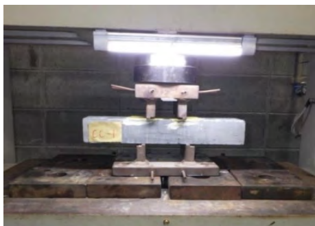
写真-3 従来のせん断試験装置による試験状況
