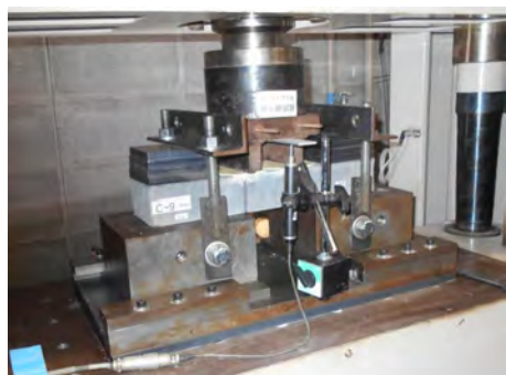
写真-4 改良したせん断試験装置による試験状況
