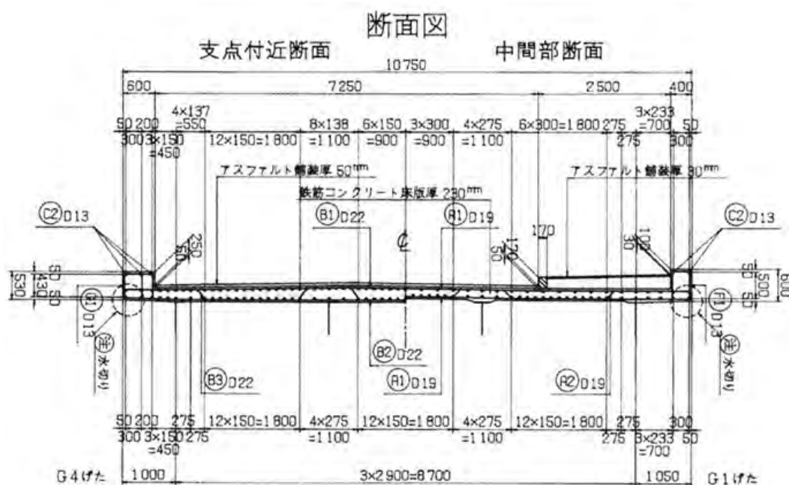
図－2 選定した橋梁における RC 床版の断面図
