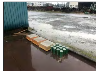
写真-3 供試体の暴露状況
