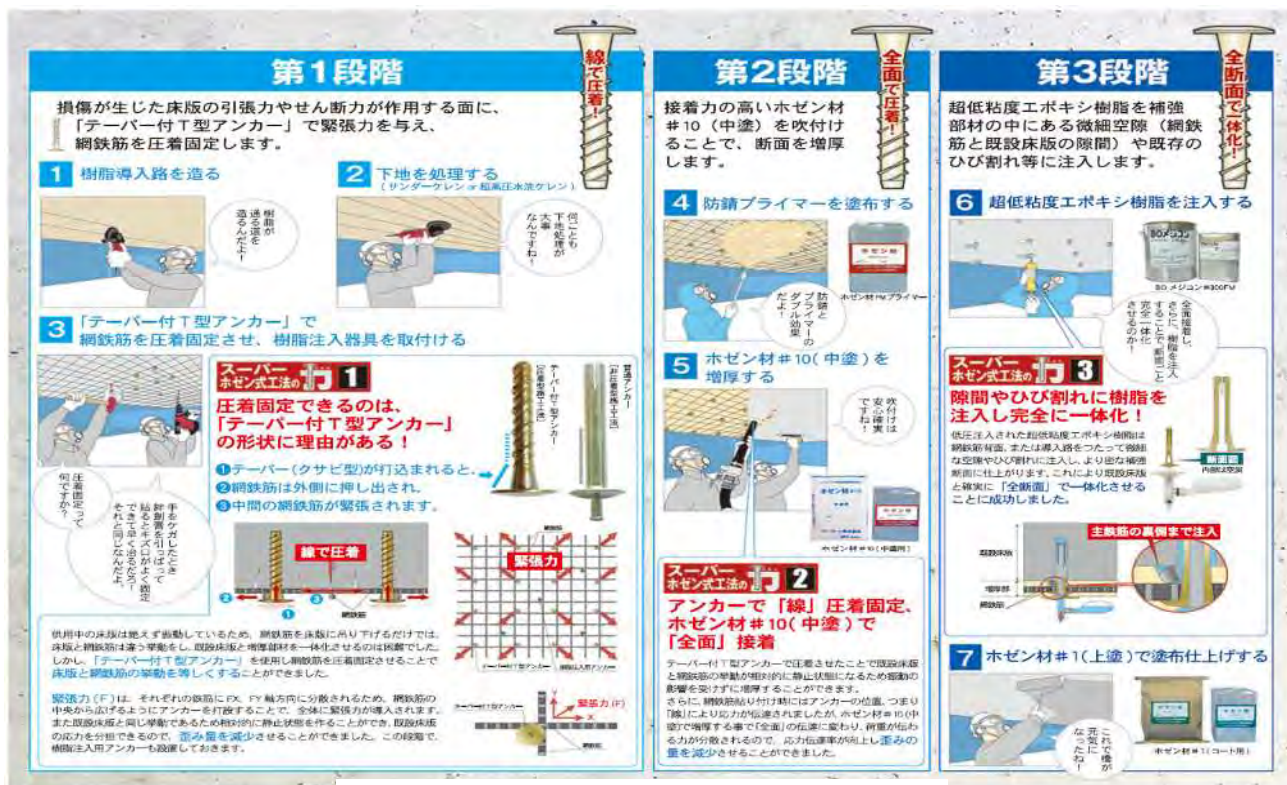
図－3 ひび割れ補修併用下面増厚工法の施工手順
