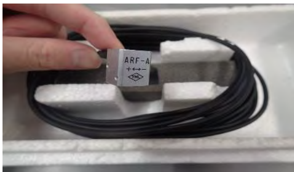
図-11 小型低容量加速度計 (ARF-50A)
