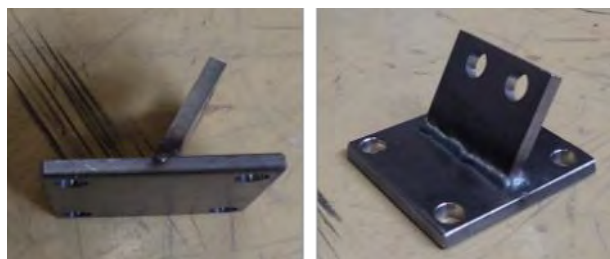
図-6 横桁取り付け用ガセット (斜角 60°)
