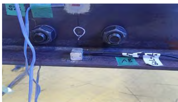
図-14 加速度計設置状況 (支間中央)
