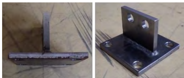
図-5 横桁取り付け用ガセット (斜角 90°)
