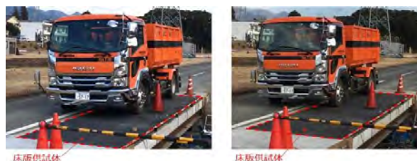
図-6 車両走行状況（左：床版中央、右：床版端）
