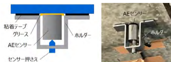
図-5 AE センサーの床版への設置状態
