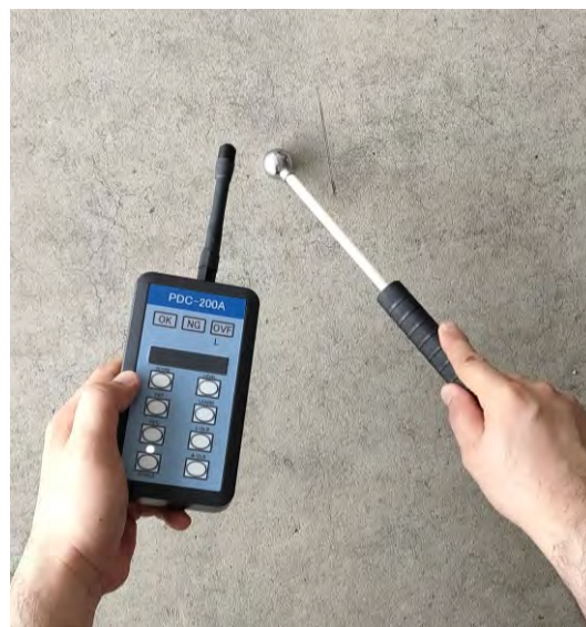
写真-3 打音取得機器 (PDC-200A)
