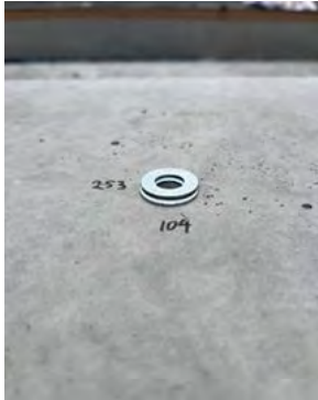
写真-3 ワッシャー2枚で隙間を再現
