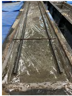
写真-2 上段鉄筋設置
