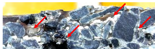
写真-9 砂利化部補修材浸透状況
