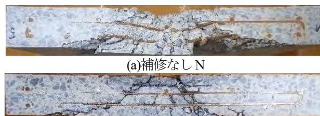
写真-8 モルタル容積比 30%供試体の断面観察
