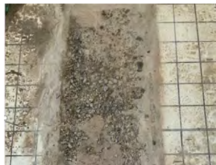
写真-5 RC床版供試体の砂利化発生状況
