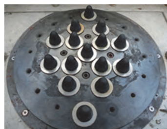
写真-3 受圧板と制振ゴム（装置 A）
