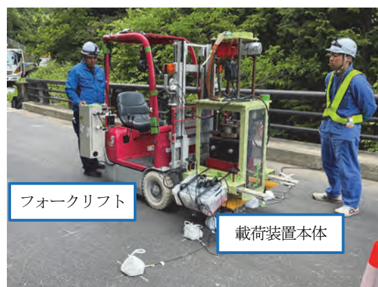
写真-1 衝撃荷重載荷試験計測状況
