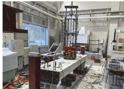
写真-5 衝撃载荷試験状況 (装置 B)
