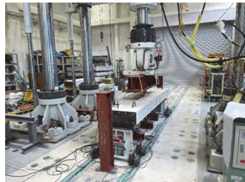
写真-6 静的载荷試験
