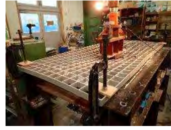
図-10 試験体 1-3 破壊状況
