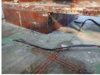
図-11 試験体 2-1 荷重点破壊状況
