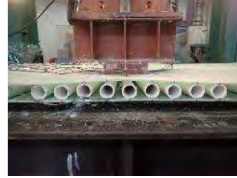
図-12 試験体 2-3 破壊状況
