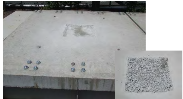
写真－2 砂利化の模擬状況
