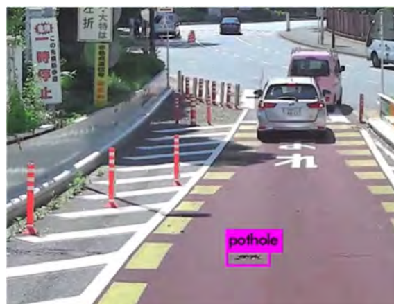
図ー8 AIによるポットホール検知
