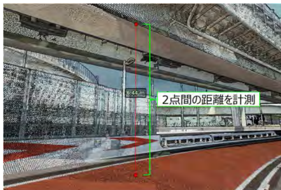
図－4 点群データによる距離計測
