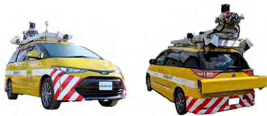
図－3 InfraDoctor で用いている MMS
