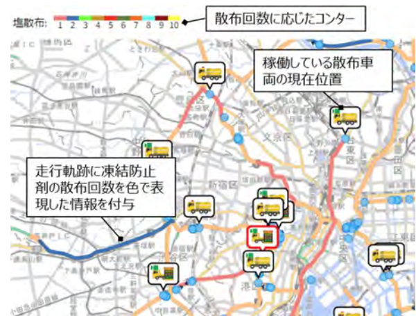
(b) 凍結防止剤散布状況
