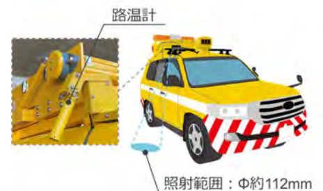
図－10 交通PCに設置した路温計
