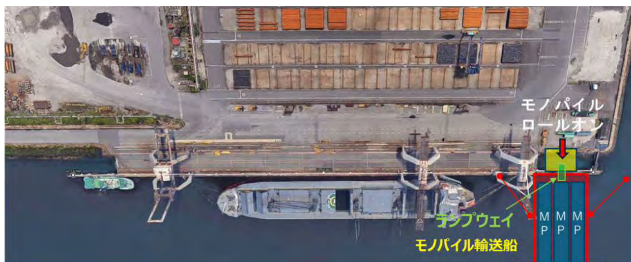
図 3-6 モノパイル輸送船係留配置図 9)
