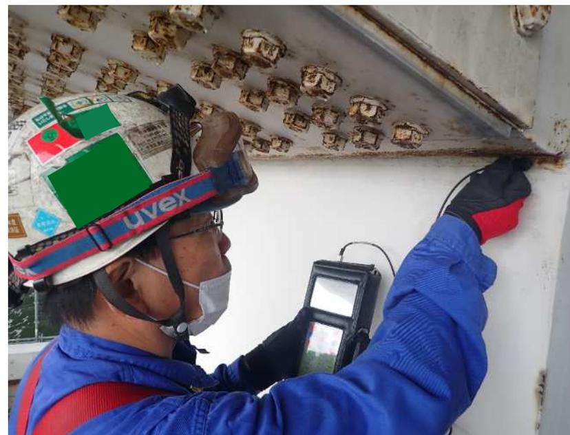
鋼製橋脚隅角部での渦流探傷試験(ET)
