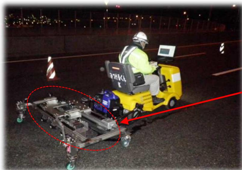
損傷によって変化する渦電流を検知する渦流探傷法を活用
