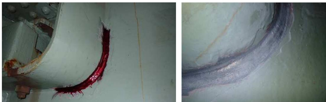
浸透処理状況と試験結果 ※き裂の指示模様なし
