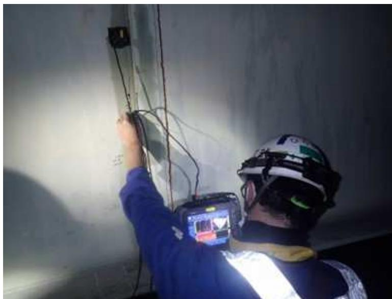
鋼桁へのフェイズドアレイ(PA)調査
