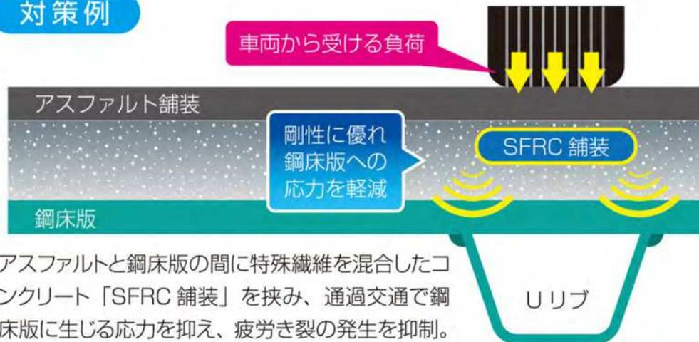
アスファルトと鋼床版の間に特殊繊維を混合したコンクリート「SFRC 舗装」を挟み、通過交通で鋼床版に生じる応力を抑え、疲労き裂の発生を抑制。
