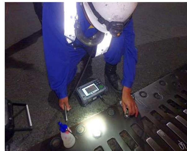
ボルト部の超音波探傷試験
