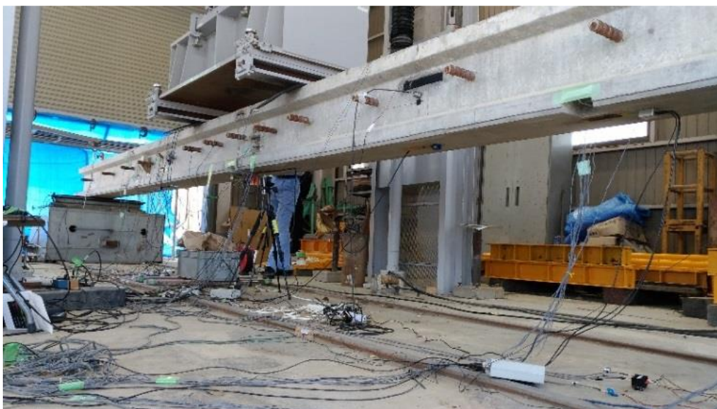
図 2 位相空間分析の適用を検討した PC 桁（文献 3）、4）で検討
