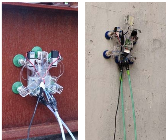
図1 表面吸着により腐食鋼部材およびコンクリート壁を移動する小型点検ロボット
