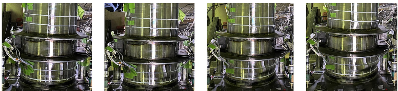
(a) 基部最大耐力時 -6\delta_0 (b) 制御部材接触時 -7\delta_0 (c) 最大耐力時 -11\delta_0 (d) 最大荷重時 -14\delta_0 図 8.1.10 鋼製橋脚の変形状態 (損傷制御)
