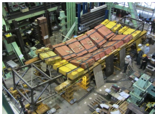
(b) 崩壊状態
