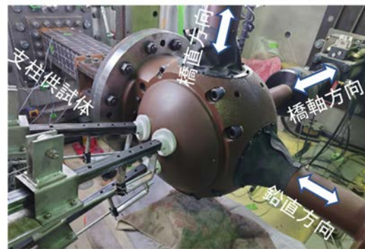
図 2.8.2 支柱試験セットアップ状況
