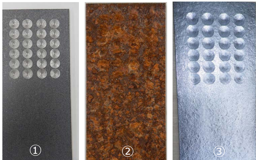
試験片 (左：試験片 中：腐食後 右：素地調整後)
