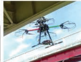
ドローンによる損傷把握
