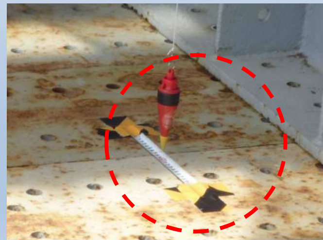
(d) 下げ振りによる計測(詳細)
