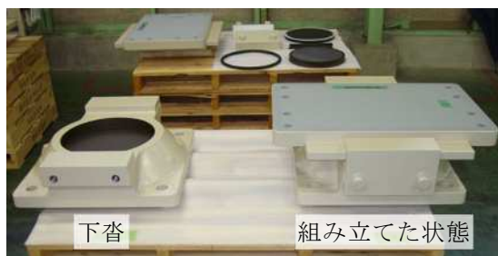
写真-1 BP-B 支承試験体（新規製作）
