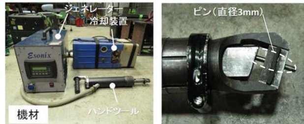
(a)UIT機材 (b)ハンドツール先端 写真-2 UIT機材とピンの形状
