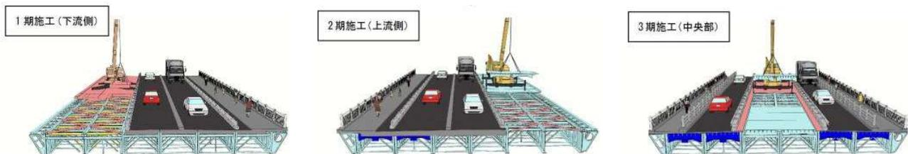
図-6 淀川大橋の床版取り替え施工のステップ図
