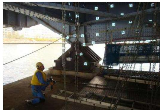
写真-3 支承部のデジタルカメラ計測
