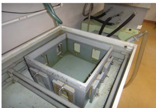
(a) 温度差耐水試験装置への試験板取り付け (試験面：内槽側（高温側）)
