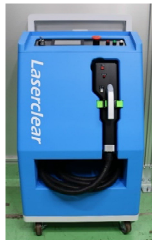
図 3.2.1 100W パルスレーザー発振器を搭載したレーザークリーニング装置外観
