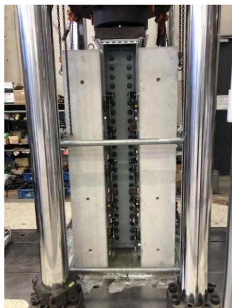
図-3 押抜き試験方法
