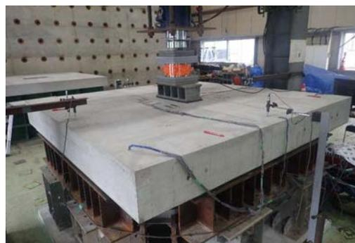
写真-2 押抜きせん断試験の試験状況
