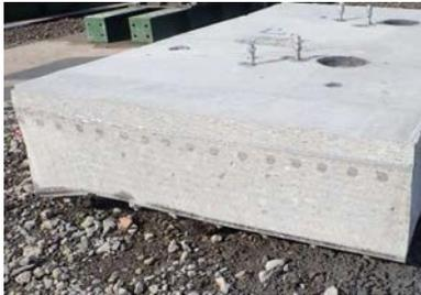
(h) 間詰部切断面（配力鉄筋断面）
