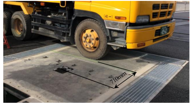
写真-3 車両走行による振動計測
