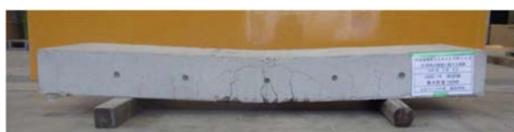
写真-2 Case1 のひび割れ状況
