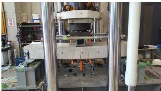
写真-1 曲げ載荷試験の様子 4)
