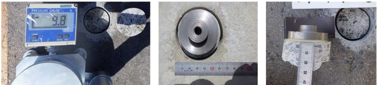
写真-6 付着強度試験状況
