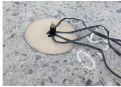
図-4 床版上面に設置したずれ検知棒
