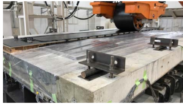
写真-4 輪荷重走行試験状況（本載荷）
