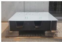
(1)研掃工・防錆処理
